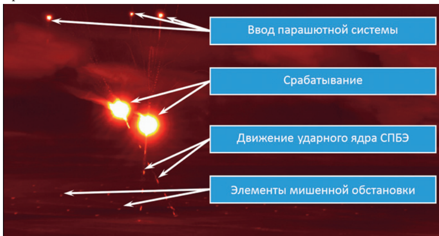
Рис. 3. Термограмма функционирования СПБЭ
